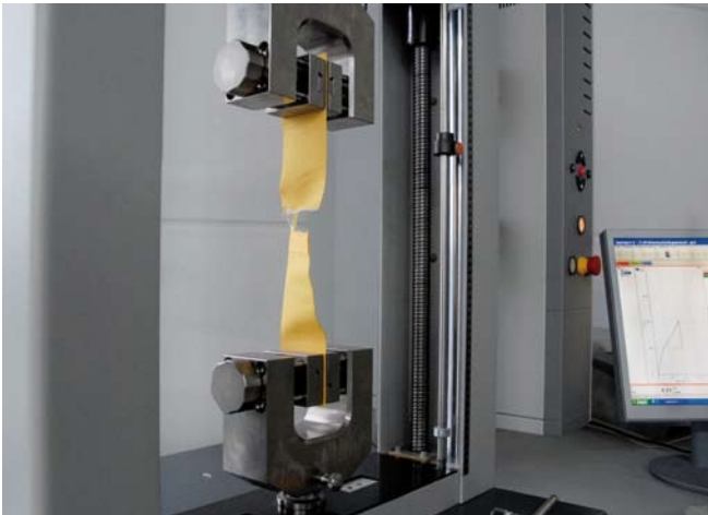
Eine Zwickprüfmaschine testet die Qualität des verklebten Gewebes.
