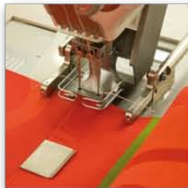
Der Nähkopf ist als 1- oder 2 Nadel Version erhältlich. Es werden ausschliesslich Nähköpfe von namhaften Markenherstellern wie Pfaff oder Dürkopp Adler verwendet.
