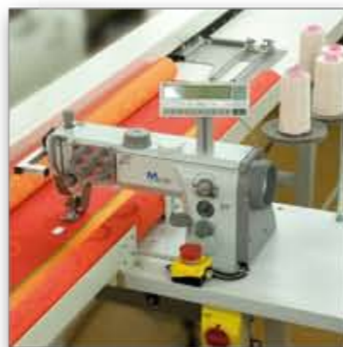
Einfache Bedienung der Anlage mittels Display direkt am Nähkopf
