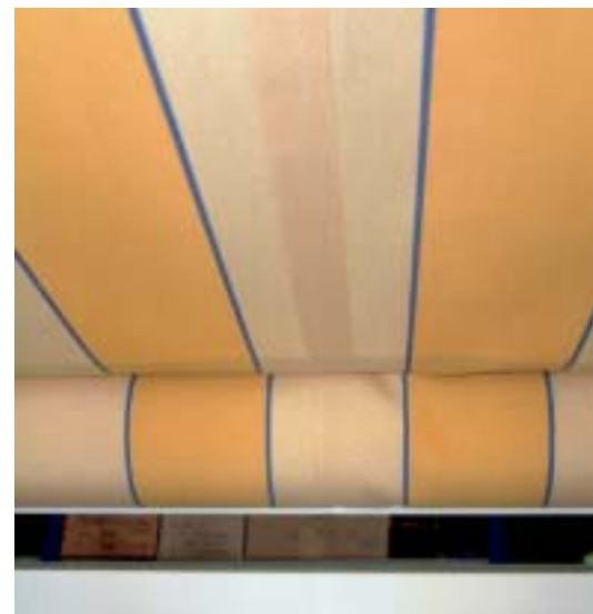
Leichte Wickelfalten im Nahtbereich (Hotmelt)
