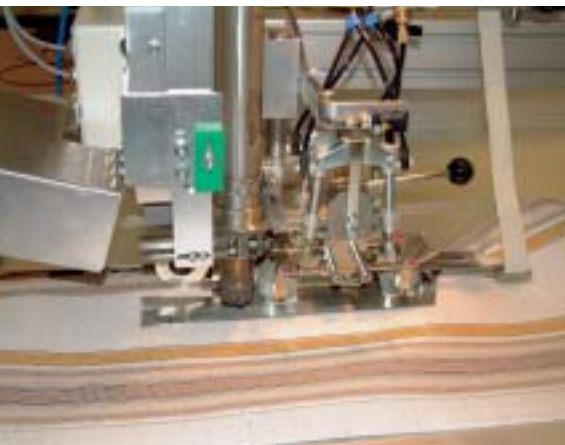
Führungsapparat und Heizeinheit beim Heißluftschweißen (Jentschmann)
